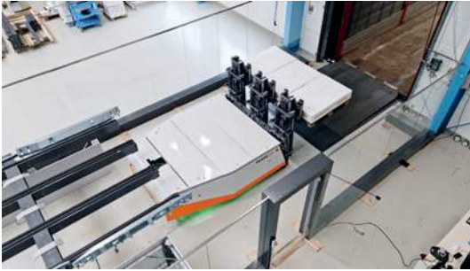
Das TRAPO Loading System (TLS 3600) zum voll automatisierten Be- und Entladen von Lkw
